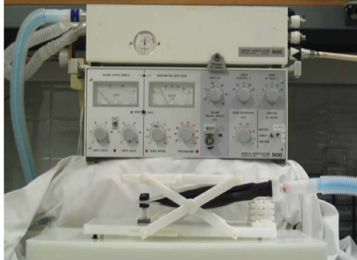
FIG. 2.12: Photographie du respirateur et de la plateforme mobile utilisés pour simuler des mouvements périodiques.
