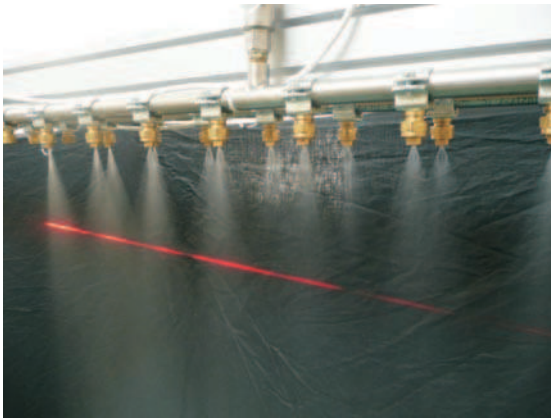
(a) Exemple typique de double rampe. Mise en évidence du phénomène de diffusion (dans le visible ici) à l'aide d'un laser He-Ne
