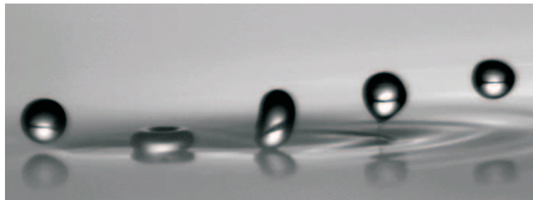
FIGURE 2 – Rebond de gouttes sur film liquide [Le Clercq, 2000]
