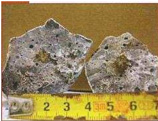
Fig. 1. 17 : Nodule de chaux dans un grain de laitier d'aciérie de conversion [BOMBAY, 2004]
