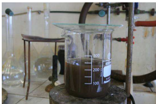
Solution contenant 200 ml d'eau distillée, 1 g du BS séché sous vide et 30 g du sucre
