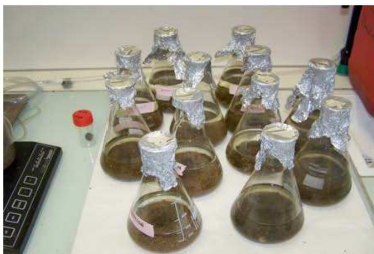
Microcosmes de sédiments non brassés - non oxygénés
