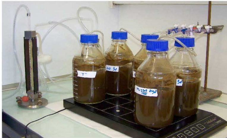
Microcosmes de boues biologiques brassées - oxygénées
