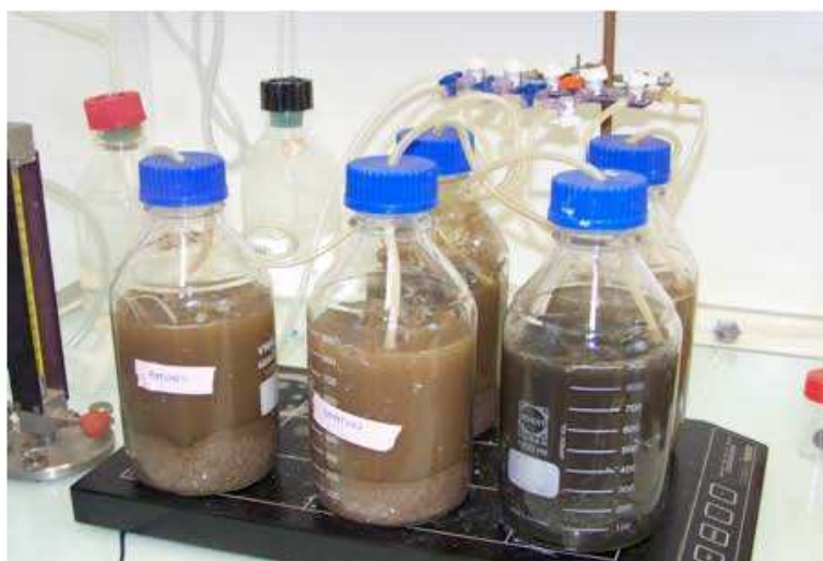
Microcosmes de sédiments brassés - oxygénés
