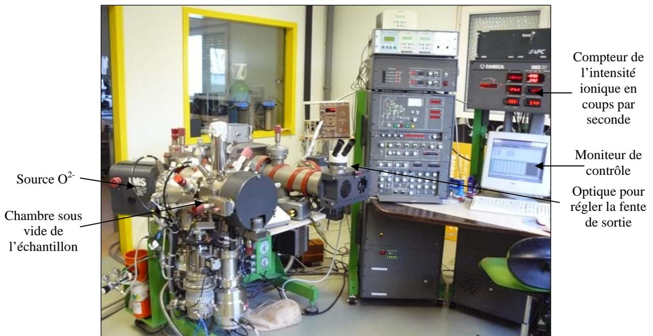
Figure A6. Microsonde ionique CAMECA IMS-3f au CRPG
