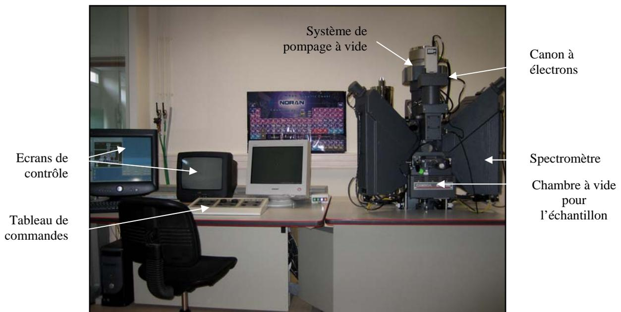
**Figure A5.** Microsonde électronique CAMECA SX100
