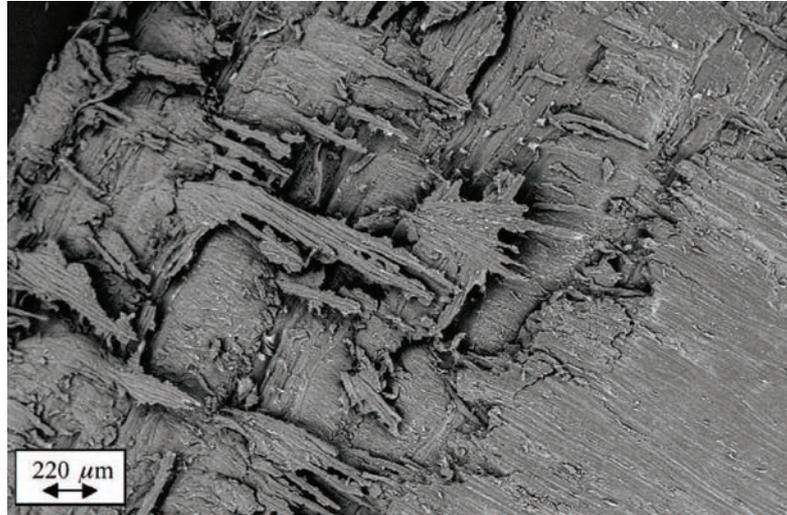
Figure 2: Enchevêtrement des fibres dans l'interface de soudage
