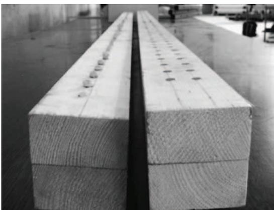
**Figure 26 :** Assemblage soudé (gauche) et assemblage cloué (droite) en prévision d'essais en flexion (Bocquet et al. 2007).
