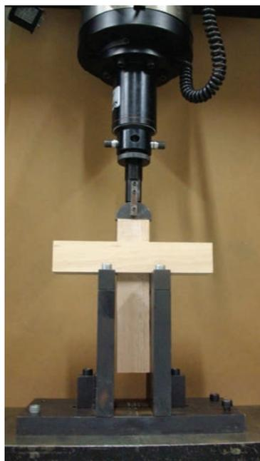
*Figure 59 : Dispositif de l'essai mécanique (compression).*
