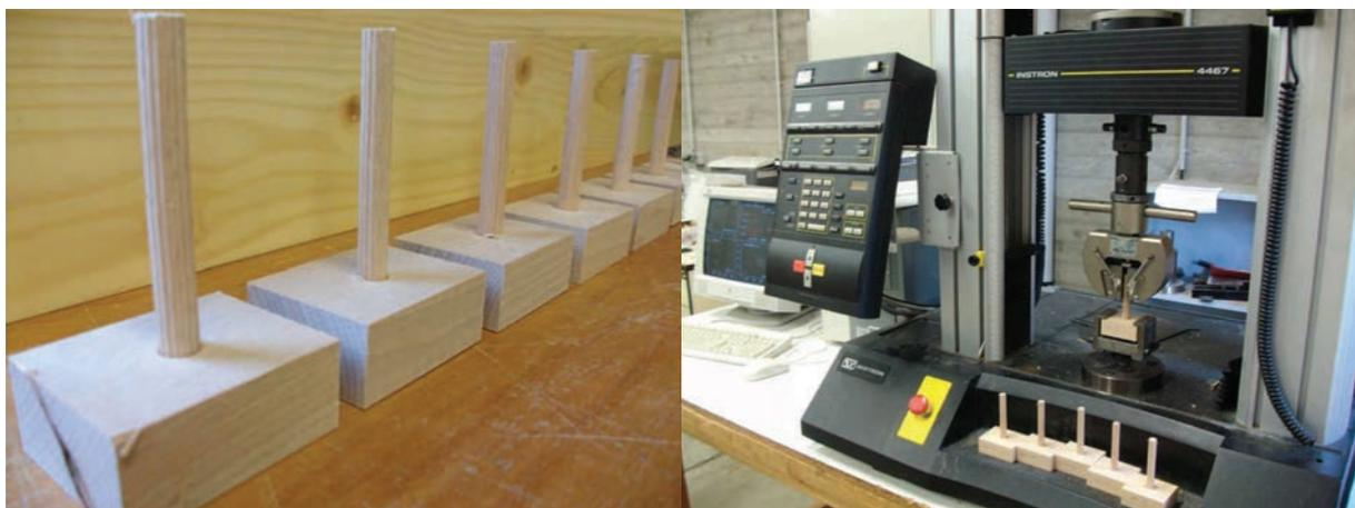
Figure 49 : Echantillons utilisé pour accélération et vitesse constante (gauche) ; essai mécanique de traction - INSTRON 4467 (droite).
