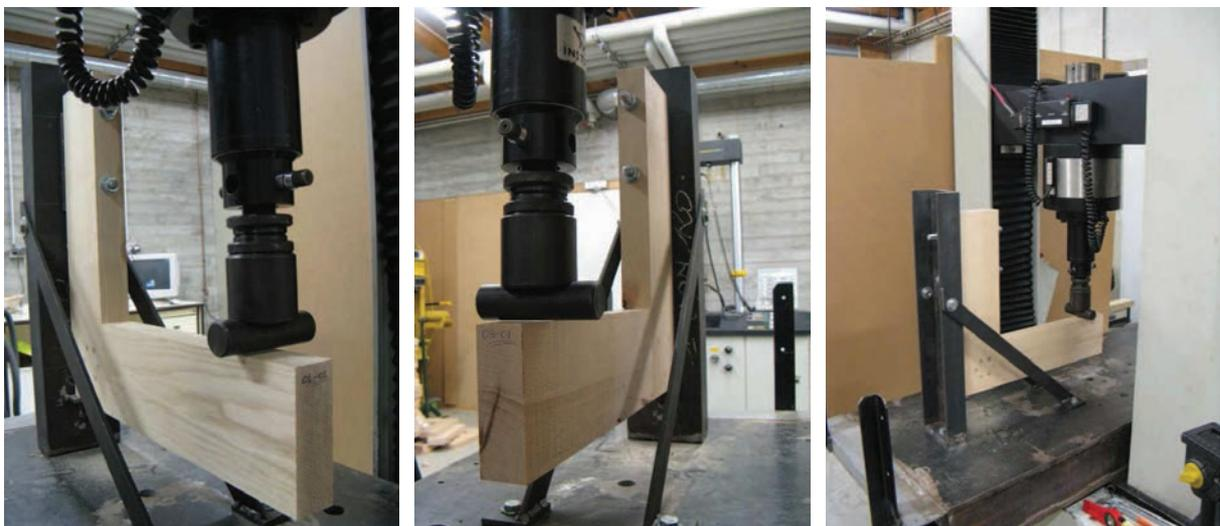
Figure 55 : Dispositif d'essai mécanique pour les assemblages type L en traction sous différents angles.
