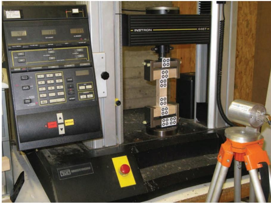
Figure 54 : Dispositif de l'essai mécanique pour les assemblages type T.
