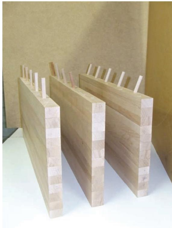
*Figure 59 : Panneaux soudés avec trois angles d'inclinaison par rapport à la normale à la surface d'insertion (de gauche à droite : 0°, 10° et 20°).*
