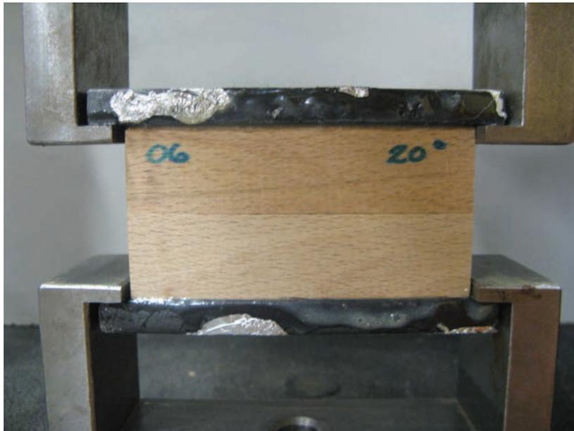
*Figure 58: Dispositif de l'essai mécanique en traction pour lamellé-soudés.*
