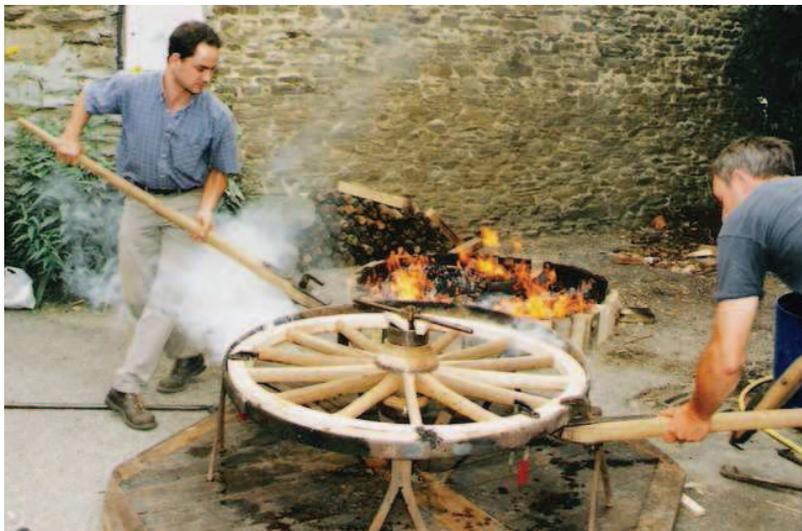
Figure 43 : Frettage d'un cerclage de roue de charrette.
