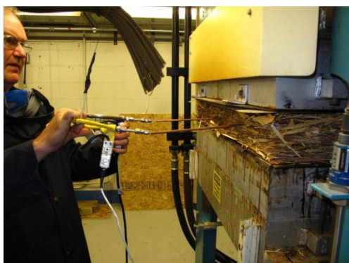
figure 76: Insertion de deux PressMan dans le panneau
