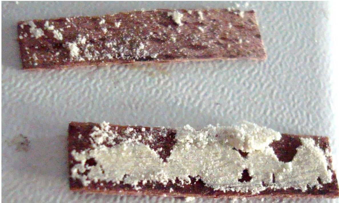
figure 94: Epreuve de placage de hêtre avec MPU200R après TMA - mauvaise adhésion et cohésion
