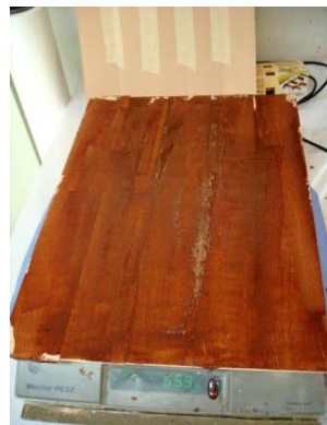
figure 67: Lames de hêtre après l'application d'un mélange de colle PF-MPU
