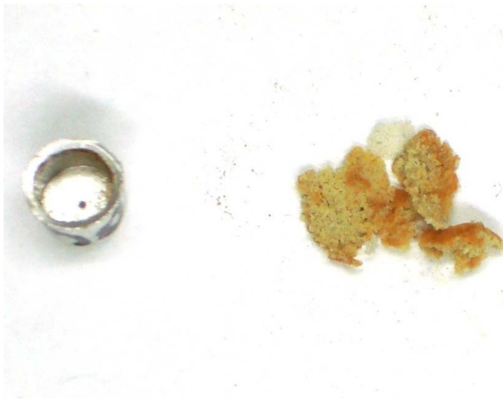
figure 90: Cuvette vide avec l'éprouvette écrasée, chauffée à 300°C
