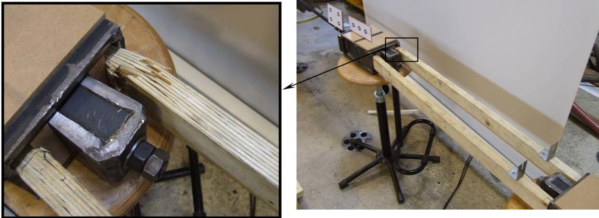
Figure 218 : Mode de rupture du système nouvel assemblage précontraint – avivés en LVL
