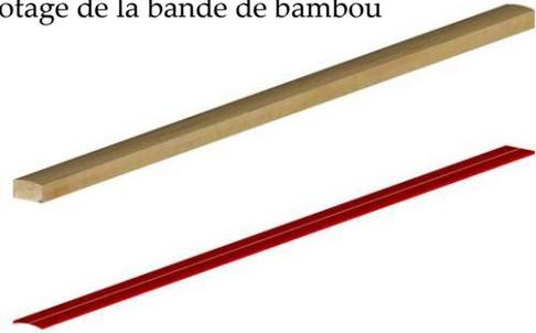
③ Usinage de cylindres dans la bande de bambou
