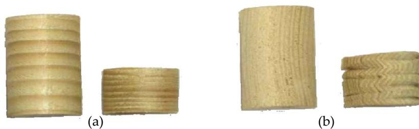
Figure 83 : Eprouvettes avant puis après compression
