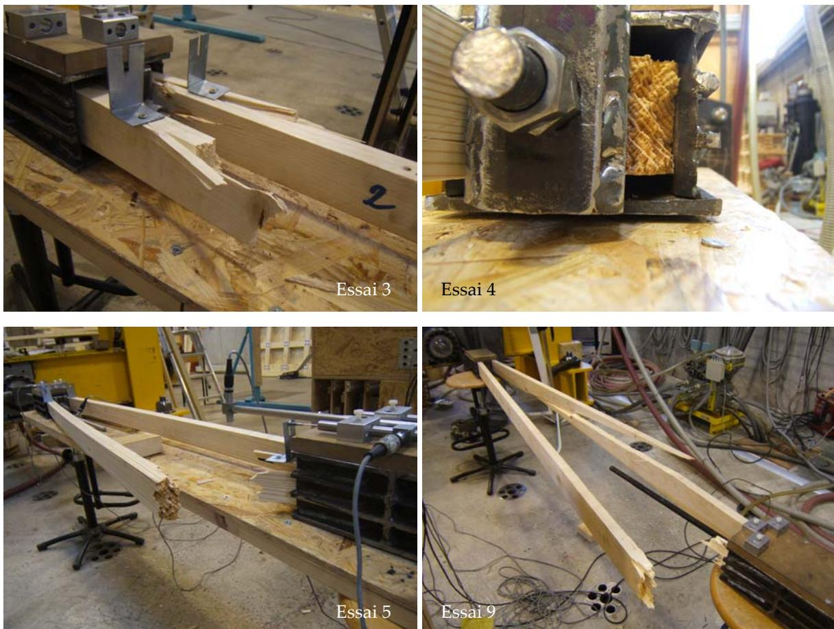
Figure 79 : Ensemble avivés – assemblages précontraints ayant subit une rupture dans un de ses avivés
