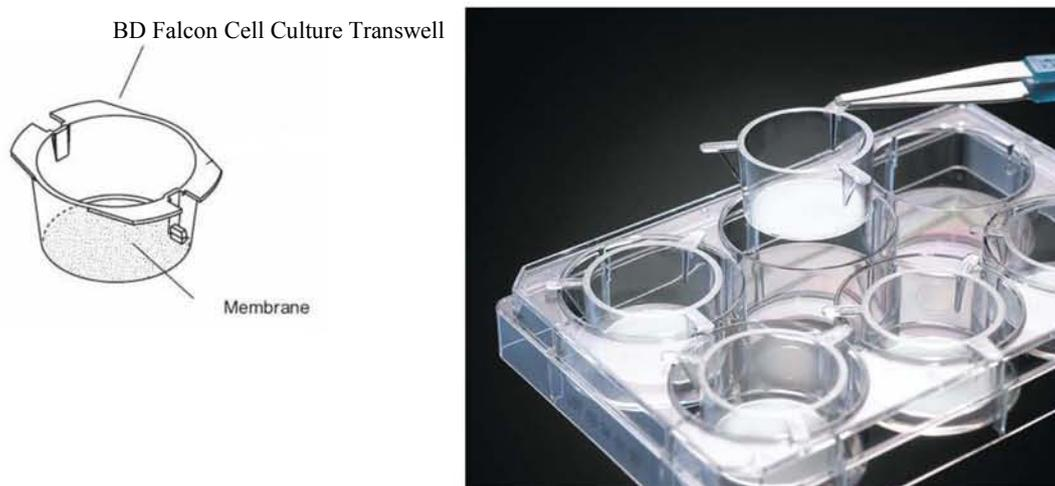
**Figure 34 : Schéma du système de co-culture (BD Falcon<sup>TM</sup>).**
