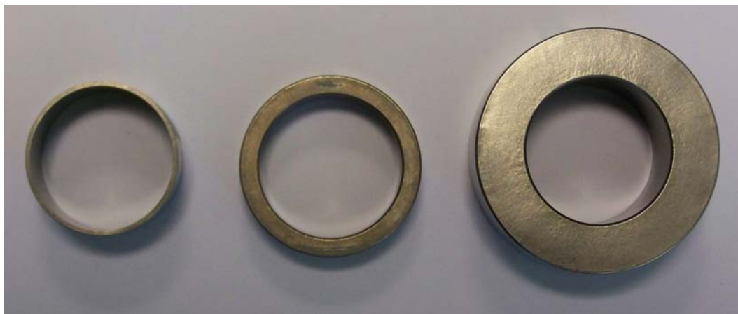
FIG. 4.2 – Photographie des 3 types de bagues utilisées. De gauche à droite : bague fine (épaisseur 0,89 mm), bague moyenne (épaisseur 3,58 mm), bague épaisse (épaisseur 8,99 mm)
