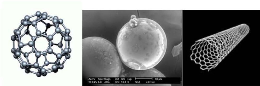
Figure 3 : Exemples d'architectures permettant la complexation d'ADN ou d'ARN. De gauche à droite, fullerène, billes de latex et nanotube de carbone.
