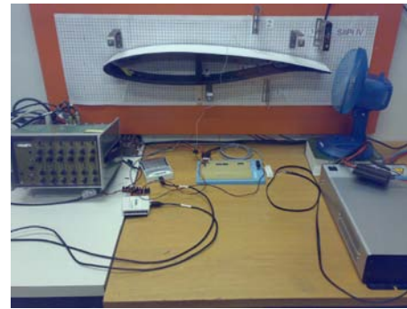
(b) Profil d'aile d'avion adaptatif [Ahola 2008]
