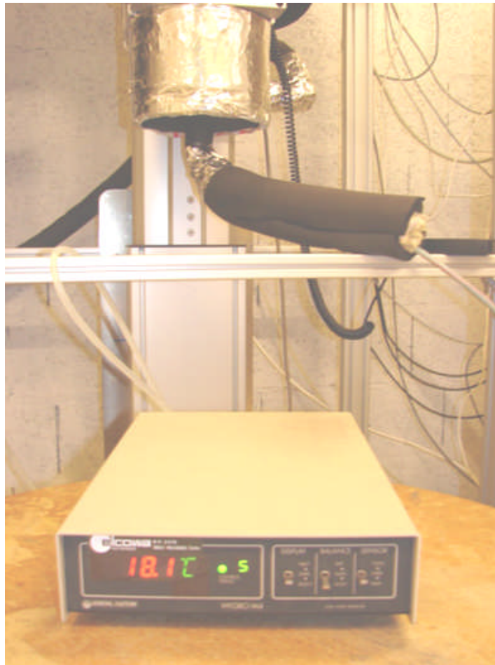
figureIII.10 : Photo du montage du capteur de point de rosée
