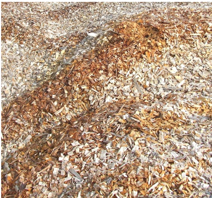
Figure 52 : Essai 4 – cheminées d'évacuation de vapeur d'eau
