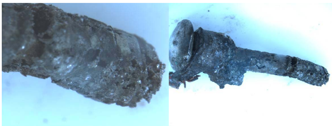
Figure 57 : Pointe inox dégradée suite à l'essai
