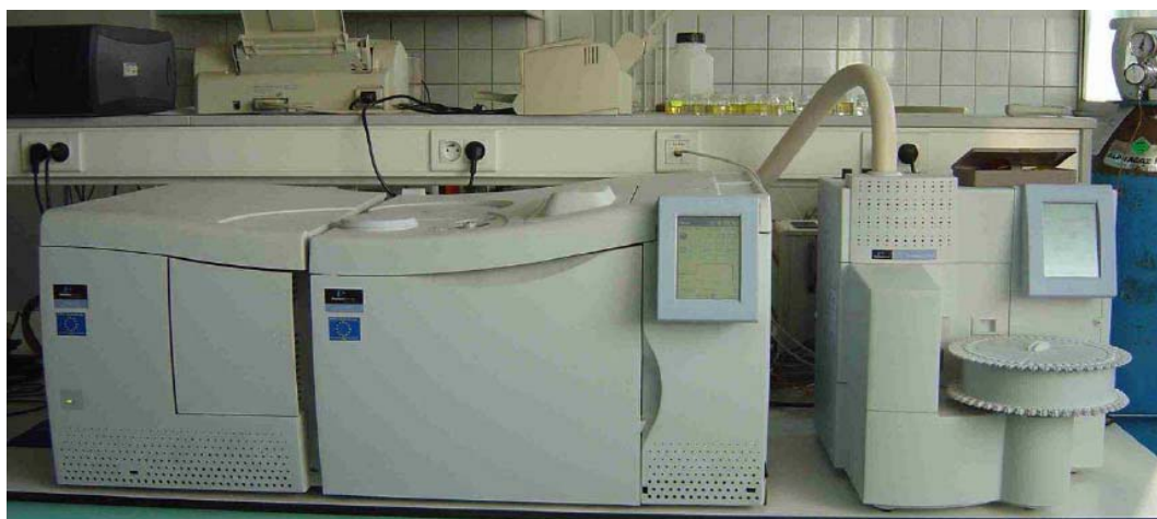
Figure 37 : Vue d'ensemble du thermodésorbeur et du système d'analyse chromatographique
