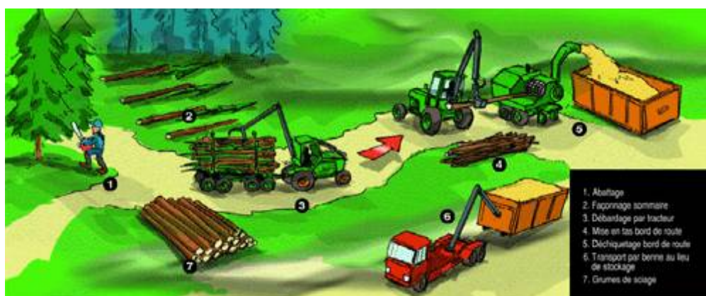
Figure 5 : Étapes de la production des plaquettes forestières
