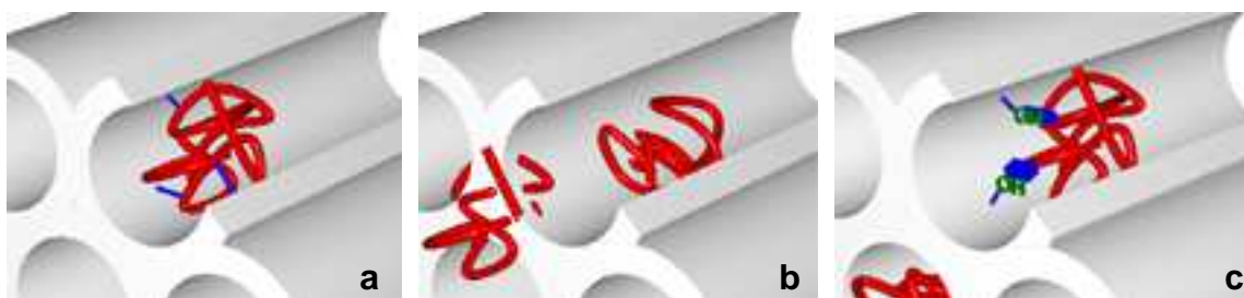
Figure V-2 : Représentation des différentes méthodes d'immobilisation, a : greffage par liaison covalente; b : encapsulation directe ; c : physisorption.
