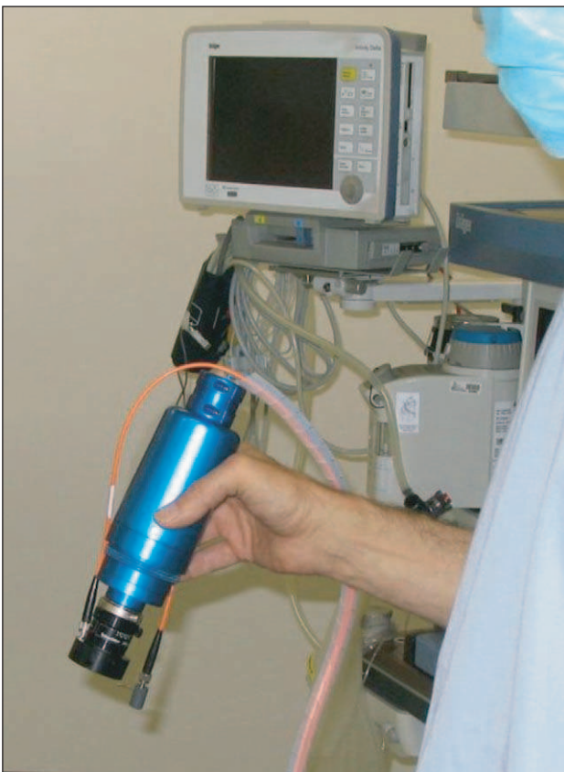
Figure 3. Sonde Fluobeam (Fluoptics) : instrument d'imagerie pour la chirurgie fonctionnant sur la base d'un système d'optique de fluorescence.
