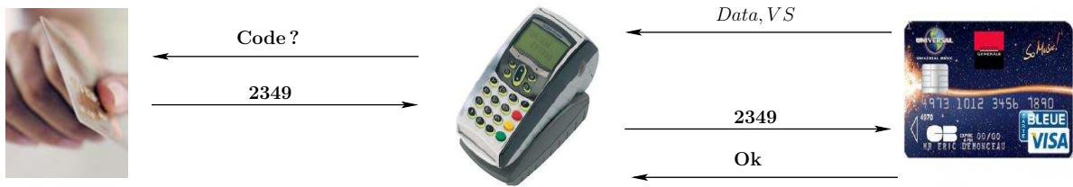
FIG. 1.1 – Échange de messages pour le paiement bancaire
