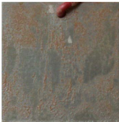
Figure IV.31 : photographie d'un échantillon traité en immersion 4 heures dans une solution de \text{HC}_{14} + \text{H}_2\text{O}_2
