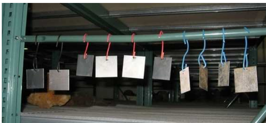
Figure IV.23 : Exposition de coupons traités sur le site de Romainville
