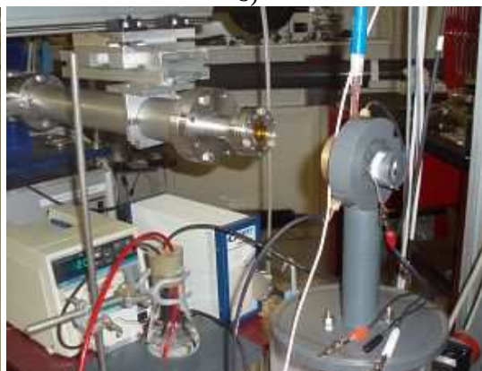
Figure II.22 : Cellule électrochimique a) démontée, b) montée de profil, c) montée de face sans plaque de carbone, d) en fonctionnement sur la ligne ID 24
