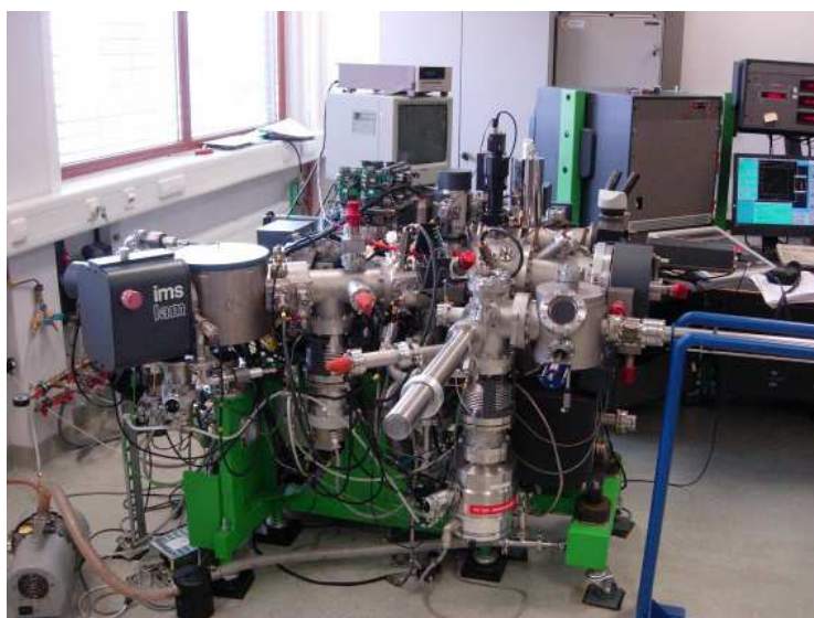
Figure 37: Spectromètre de masse à ionisation secondaire, IMS-LAM (CRPGL, Belvaux, Luxembourg).
