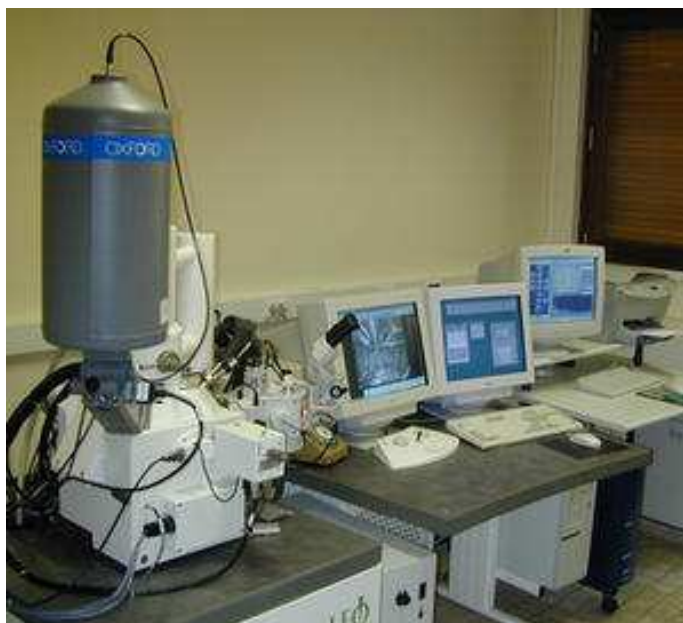
Figure 36: Microscope électronique à balayage à pression variable (INRA, Champenoux).
