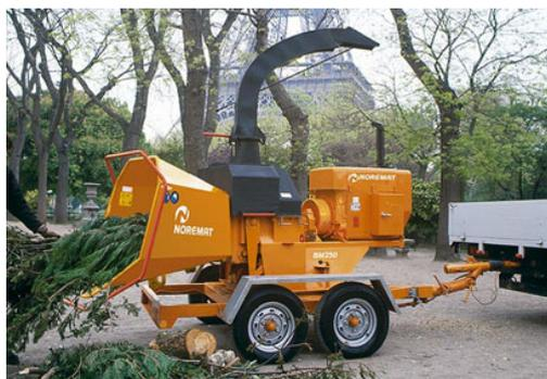
*Figure 25 : Broyeur de branche actionné par leur propre moteur*
