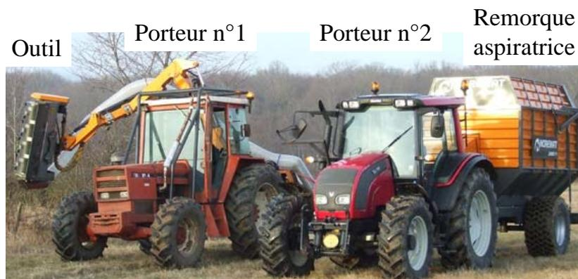
*Figure 162 : Mise en place des deux porteurs, de l'outil et du système d'aspiration*
