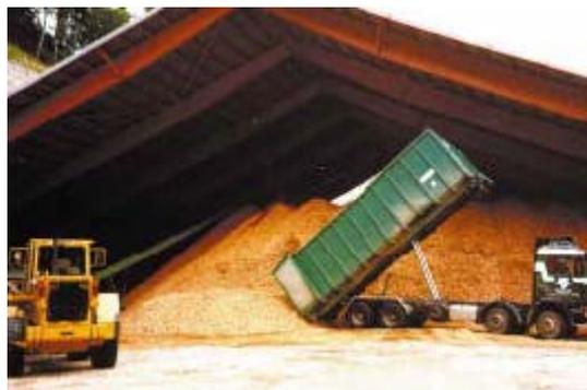
*Figure 29 : Stockage et séchage des plaquettes sous abris*
