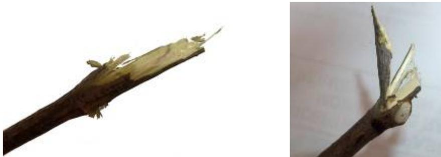
*Figure 45 : Exemple d'éclatement avec des coupes de 8mm*
