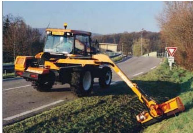
Figure 11 : Machine NOREMAT montée sur tracteur RENAULT en fauche
