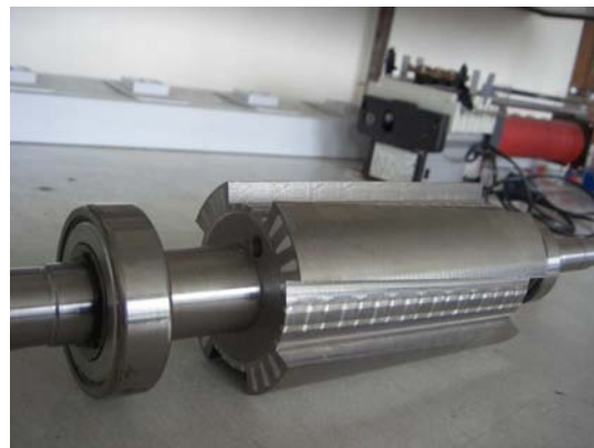
Figure IV.2 – Photographies du rotor réalisé
