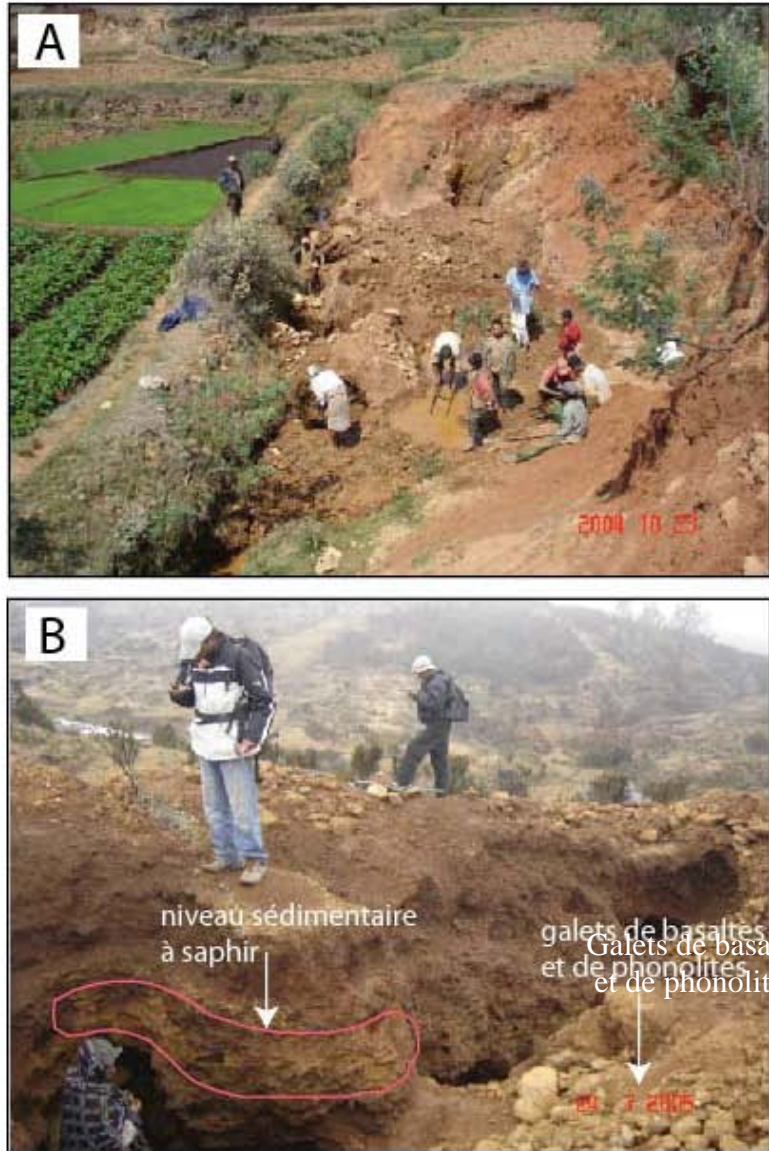
Figure IV-12: Exploitation du gisement de saphirs dans le district de Mandrosohasina, commune d'Antsirabe II. A): Gisement de Mandrosohasina où les saphirs sont exploités dans des latérites ferrugineuses déposées sur les basaltes. B): Site d'exploitation su saphir de Kianjankanaga. Les saphirs sont concentrés dans des niveaux d'argiles de couleur jaune du paléoplacer.
