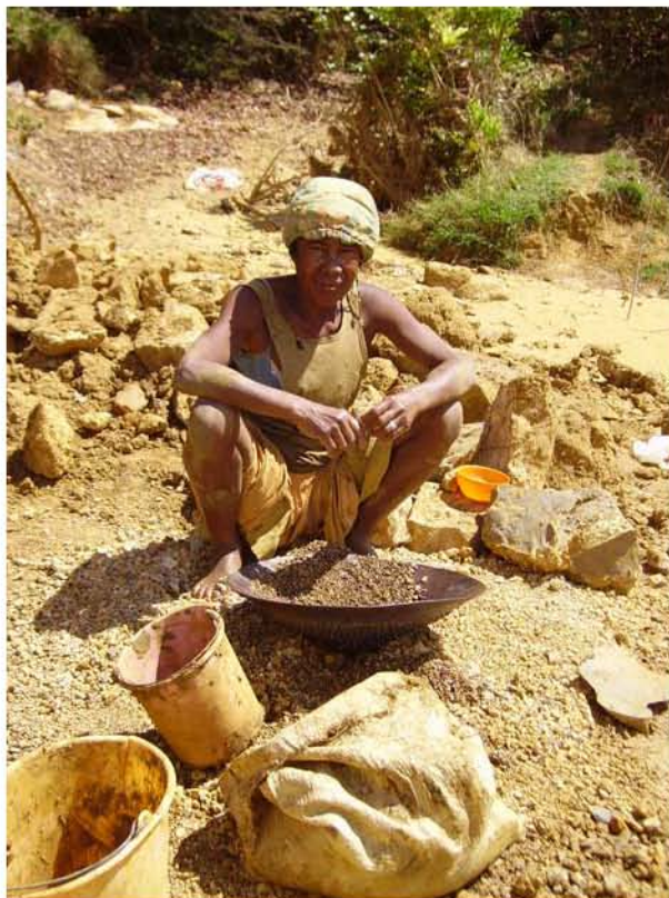
Figure II-10: Exploitation de saphirs dans des sédiments karstiques de la région d'Antsiranana, Nord de Madagascar. Le lavage des sédiments gemmifères est effectué à la bâtee.
