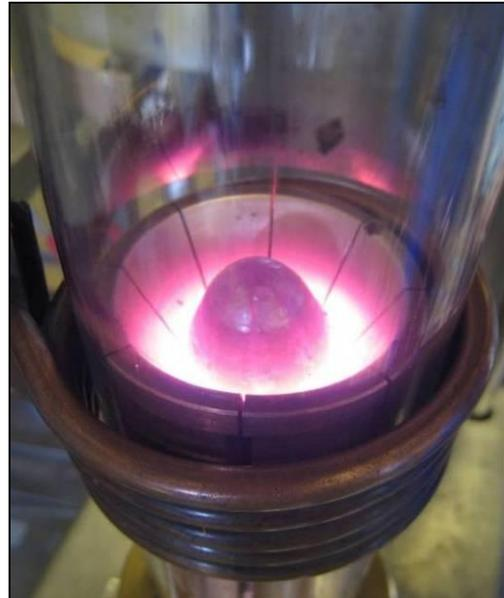
Figure 36 : Echantillon en cours de deuxième fusion.
