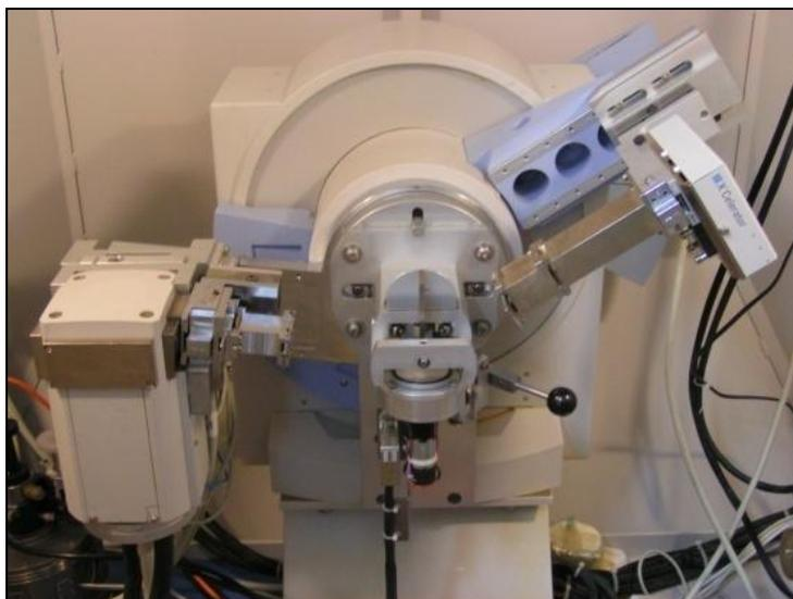
Figure 40: Le diffractomètre X'pert Pro (montage réflexion)
