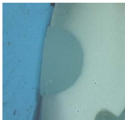
Figure 28 : échantillon de FLO (mode C40) ; absence de pénétration de colorant
