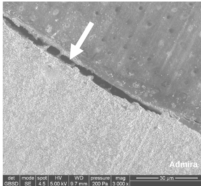
Figure 32 : Admira 3000x fracture au sein de la couche d'adhésif
