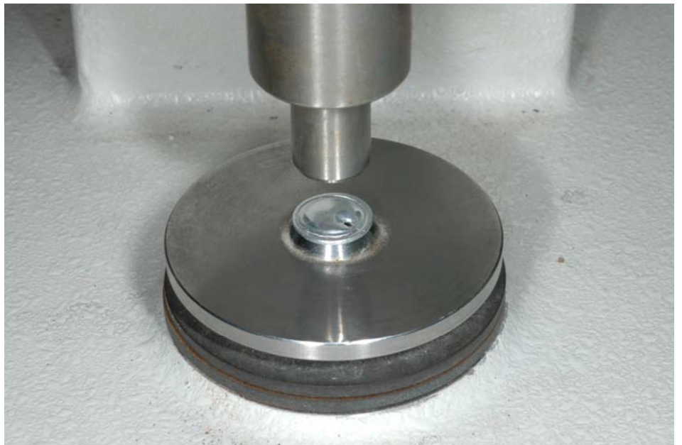
Figure 11 : sertissage d'un creuset
