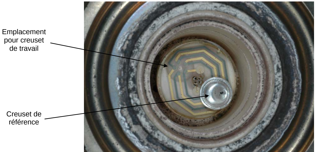
Figure 12 : chambre du calorimètre avec creuset étalon
