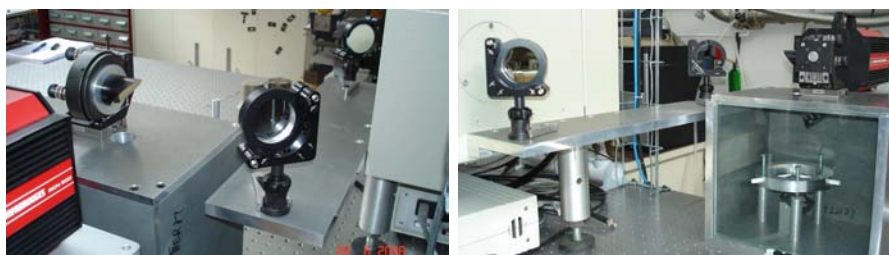
FIGURE E.8 – Photo du système de périscope pour la mesure des flux émis
