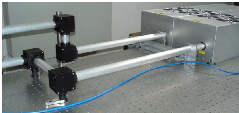
FIGURE E.7 – Photo de l'ensemble lasers avec ses cubes et tubes de protection
