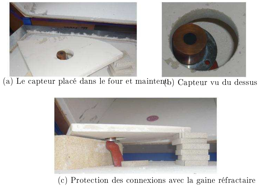
FIGURE 8.9 – Photos du montage de mesure de flux
