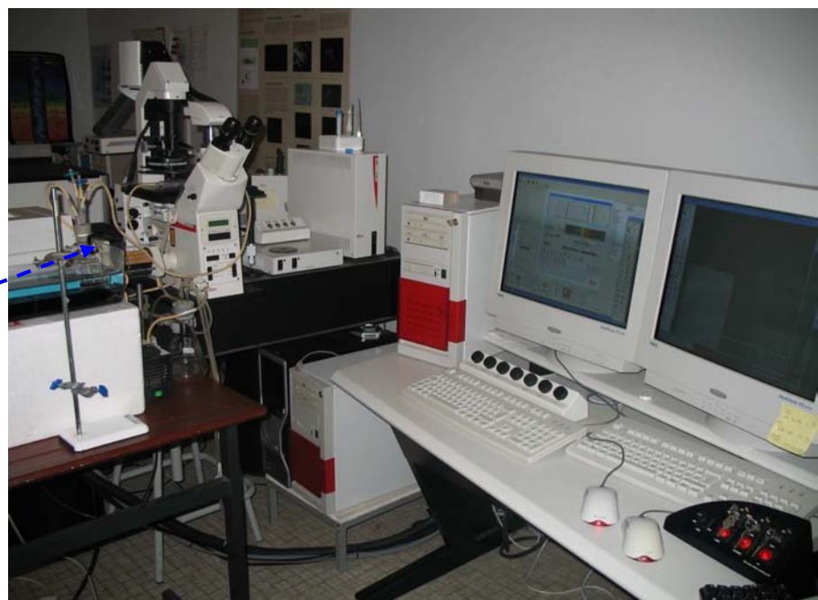
Figure-II.7A-B-C : Montage de la chambre de flux sur la plate-forme du microscope de fluorescence confocale (Leica SP2-AOBS, Germany) : Lasers utilisés (Arg 488 nm, HeNe 543 nm). A : montage vu de derrière ; B : montage vu de face. C : vu d'ensemble de l'adaptation du système en flux au microscope.
