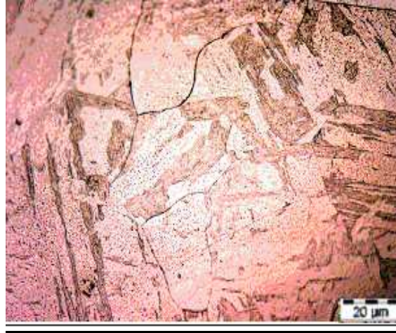
Figure III–9 : Echantillon T91 chromisé à 980°C et 1h15 puis attaqué à la solution d'acide picrique et observé au microscope optique
