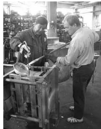
Figure I.11: photographie de la coulée par gravité d'alliages de magnésium (Fonderie SpecialValimo, Finlande).
