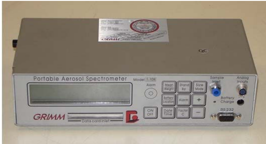
Figure 26 : compteur optique type GRIMM 1.108
