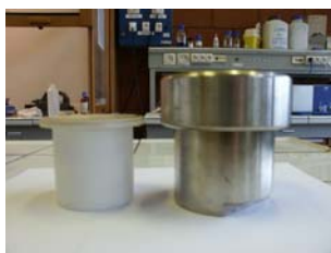
Figure 2.11: Chemise en téflon et bombe en acier utilisées pour la synthèse des mordénites
