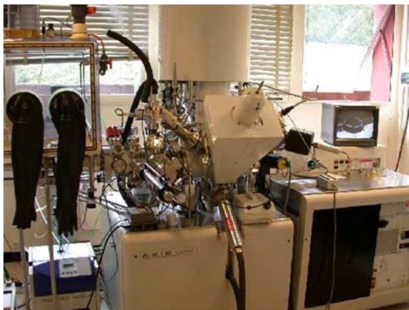
Figure 18 : Spectrophotomètre XPS Kratos Ultra 165 de l'Université de Pau & des Pays de l'Adour
