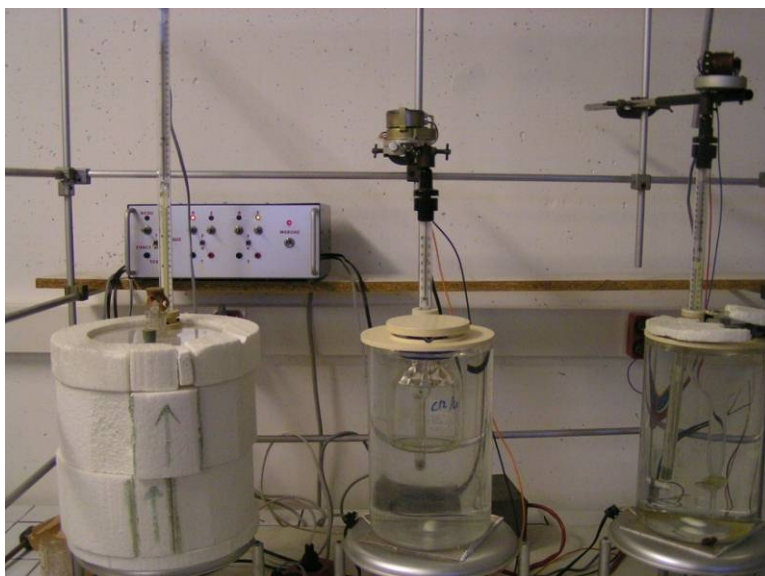
Figure 3: Manipulation de recristallisation montrant les cristallisoirs et le système de régulation connecté aux thermomètres à contact de mercure.
