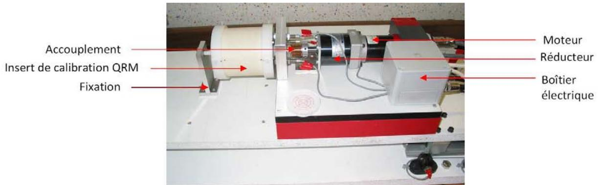
Figure 119 : Système mécanique permettant une rotation du fantôme dans l'axe z et placé sur la plateau mobile de la plate-forme.
