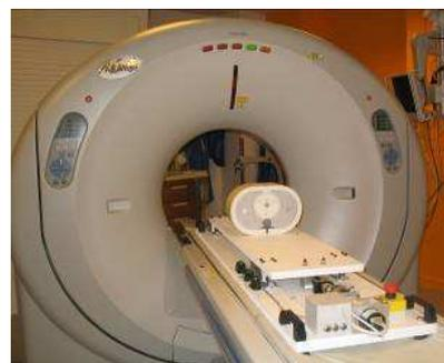
Figure 115 : L'ensemble plate-forme+fantôme QRM placé sur la table d'examen du scanner multibarrettes Toshiba Aquilion 64 CFX (Toshiba Medical, Tokyo, Japon)
