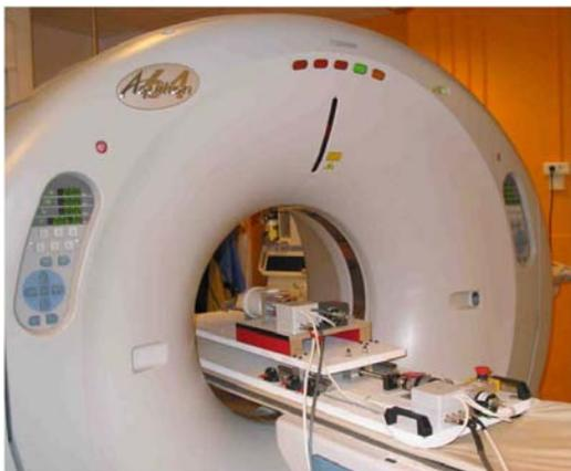
Figure 120 : La plate-forme, dans sa version translation+rotation, placée sur la table d'examen du scanner multibarrettes Toshiba Aquilion 64 CFX (Toshiba Medical, Tokyo, Japon)
