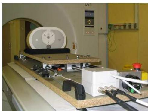
Figure 112 : L'ensemble plate-forme+fantôme QRM placé sur la table d'examen du scanner 4 barrettes Volume Zoom Siemens (Siemens Medical Solutions, Erlangen, Deutschland)
