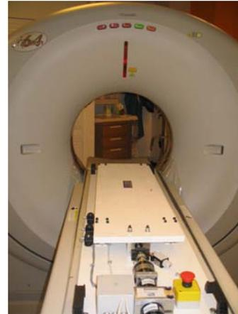
Figure 126 : L'ensemble (mire de résolution et plate-forme) placé sur la table du scanner Toshiba Aquilion 64 CFX (Toshiba Medical, Tokyo, Japon)
