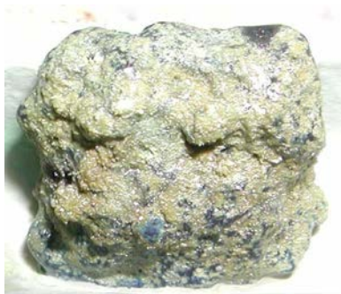
Figure V-41 : alliage 1 testé en condition cyclique à (a) 1100°C durant 4 heures et (b) 1200°C durant 12 heures (sublimation complète de la plaquette).
