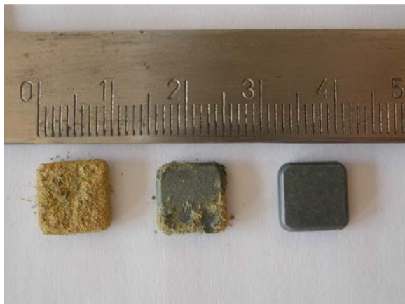
Figure V-14 : trois alliages composites de Nb ayant subi le même nombre de cycles à 815°C. De gauche à droite : les alliages MASC, 4Al et 8Al sont de plus en plus résistants au test d'oxydation. Les deux premiers alliages et particulièrement l'alliage MASC sont en cours de dégradation par la "peste".
