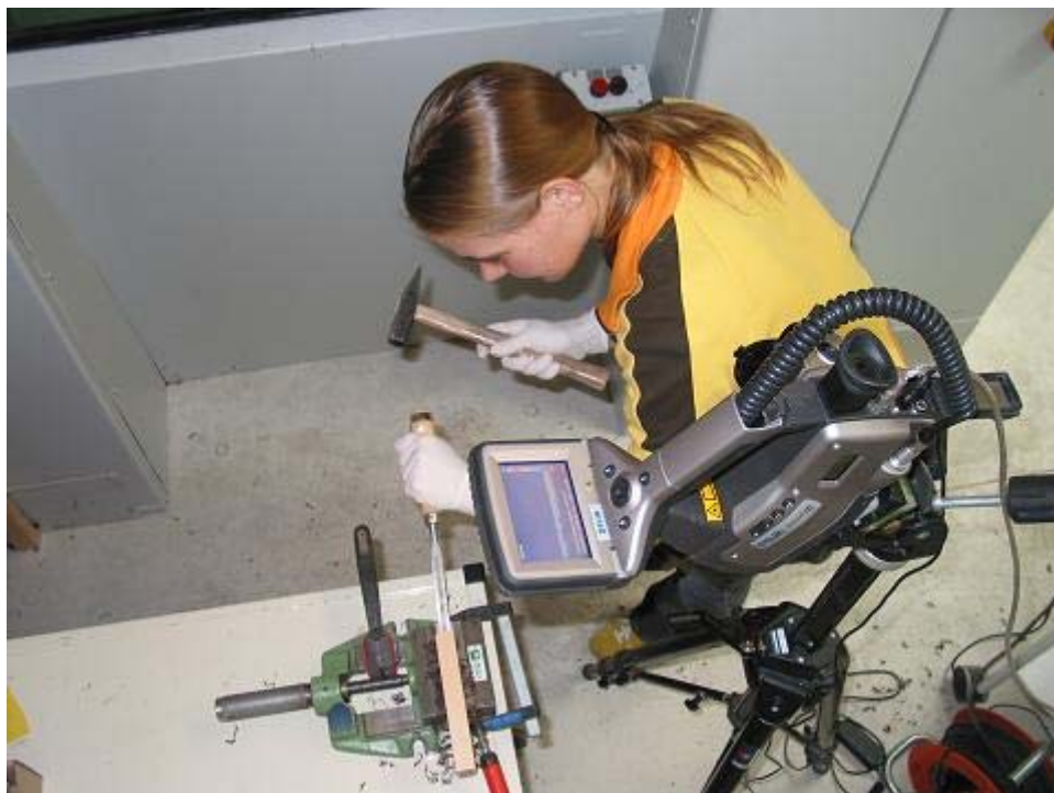
Figure 34: Ouverture d'un joint soudé filmée par caméra infrarouge.
