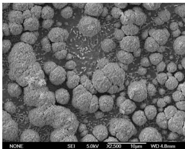
Figure II-15 : Image obtenue par SEM d'un film de diamant gravé par l'azote
