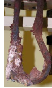
Figure 13 : Photographie de l'épingle avec dépôt de cendres.
