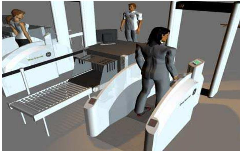
*Figure I.14 : Représentation du détecteur RQN, scanner de chaussures, développé par General Electrics (via Quantum Magnetics)*
