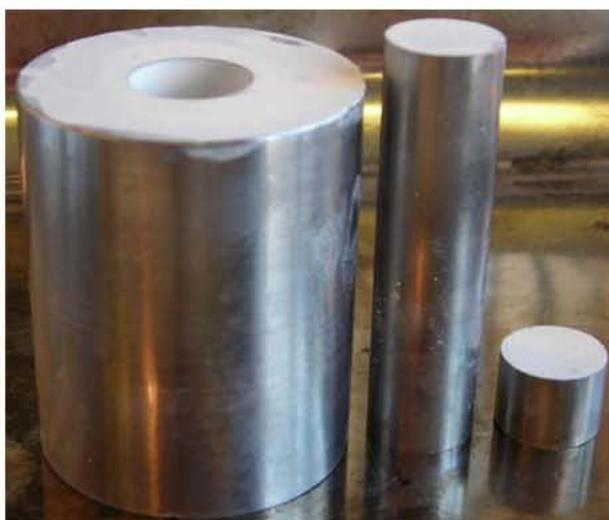
Figure 14 : Matrice, piston et contre piston recouverts de BN
