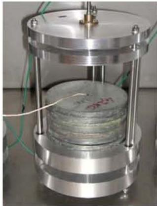
Figure 21 : Vue d'ensemble du dispositif de fluage développé pour cette étude. [CAR04]
