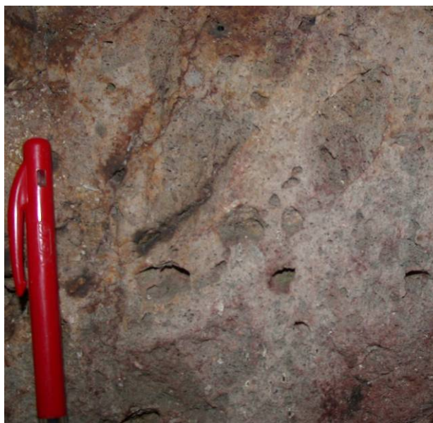
Photo 10. Détail de la roche silicifiée. On peut y observer les reliques des anciens minéraux dissous lors de la silicification.
