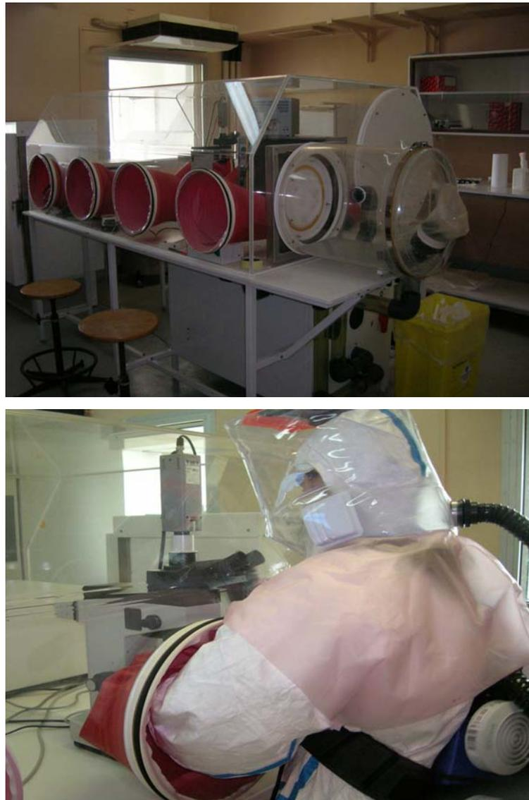
**Figure 16** : photographies de l'isolateur hermétique du laboratoire P4 du CIRMF, et du travail en combinaison et masque.
