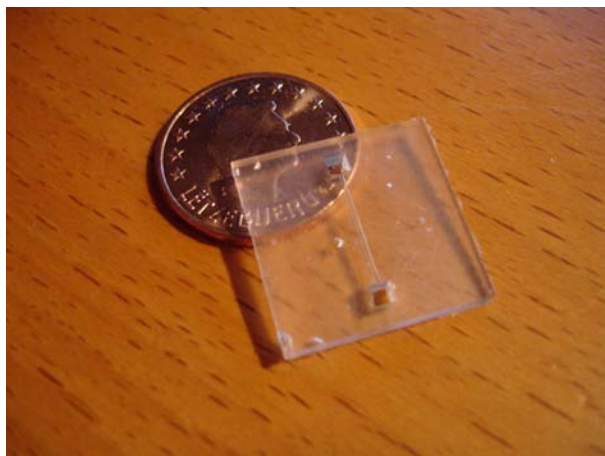
FIG. 4.15 – La pièce microfluidique en PDMS réalisé à l'aide d'une moule.
