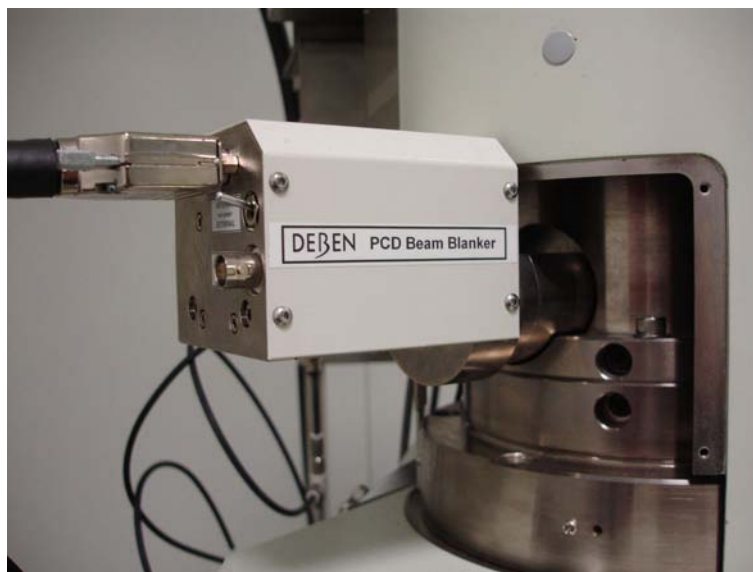
FIG. 2.5 – L’escamoteur de faisceau DEBEN installé sur la colonne du microscope électronique.
