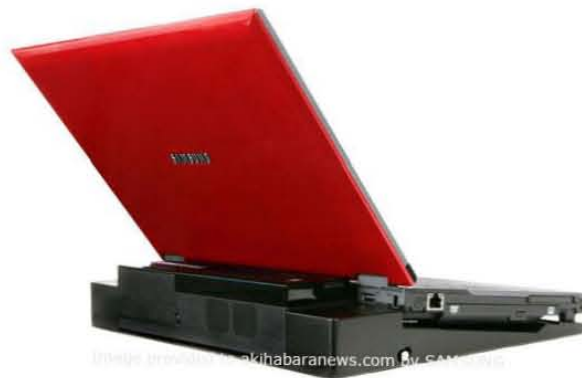
Figure 1.4 : Exemple de pile à combustible pour des applications portables. Cette pile à combustible de type DMFC est destinée aux ordinateurs portables Samsung PC Sens Q35 et permet une autonomie d'environ 8 heures avec une puissance maximale de 20W i .
