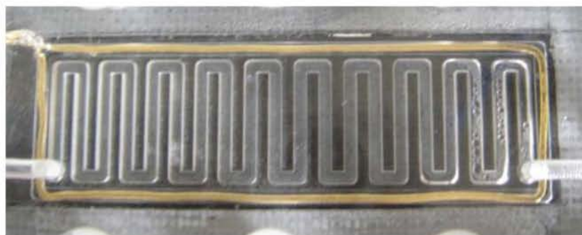
Figure 4.10. Condensation d'eau dans les canaux de gaz près de la sortie. Les gaz circulent de la gauche vers la droite (débits en gaz : air = 2l/h ; H_2 = 0.6l/h).
