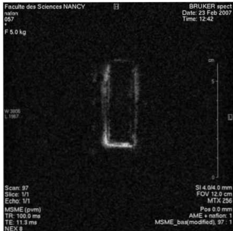
Figure 4.11. Image de l'AME du prototype de pile obtenue après 15 minutes de fonctionnement. Le support en PMMA et l'anneau d'or sont enlevés avant l'expérience d'IRM. On remarque une accumulation d'eau à l'endroit où était positionné l'anneau de collecte (Champ de vue = 12 cm, épaisseur de coupe : 4 mm, matrice = 256*256, temps de répétition = 100 ms, temps d'écho = 11.3ms, durée de l'expérience d'environ 3 min).
