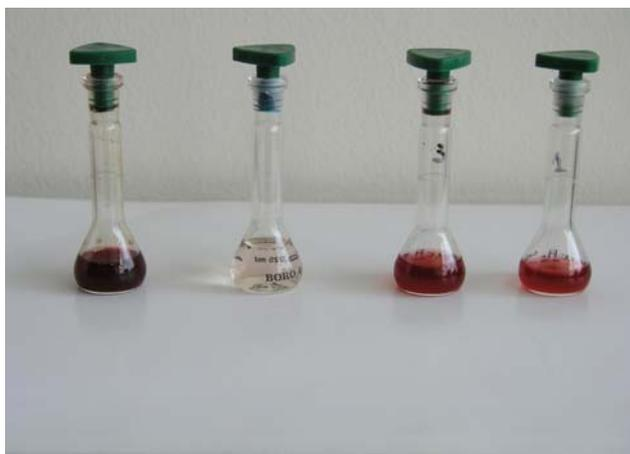
**Figure 17.** Changement de couleur du milieu réactionnel après addition de l'enzyme libre et immobilisée. De gauche à droite : GOD libre, solution témoin, GOD immobilisée à 30 mg/mL, GOD immobilisée à 10 mg/mL.
