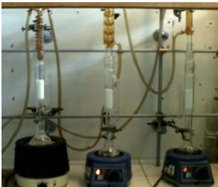
**Figure 5.** Soxhlets dans lesquels on introduit l'échantillon via des cartouches en cellulose. L'élimination du tensioactif se fait par lavage à l'éthanol.
