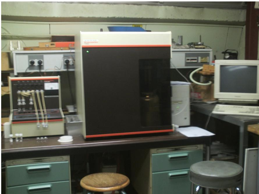
*Figure 7. Appareil Tristar 3000 (Micromeritics) utilisé pour la mesure d'isothermes d'adsorption/désorption d'azote. Il est équipé de six postes de dégazage (à gauche) et de trois postes de mesure avec une vase de Dewar pour le remplissage avec diazote.*
