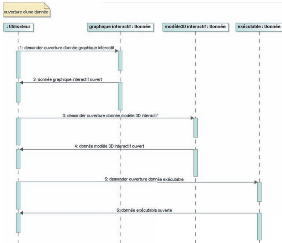
FIG. 10.15 – Diagramme de séquence décrivant l'ouverture d'une donnée
