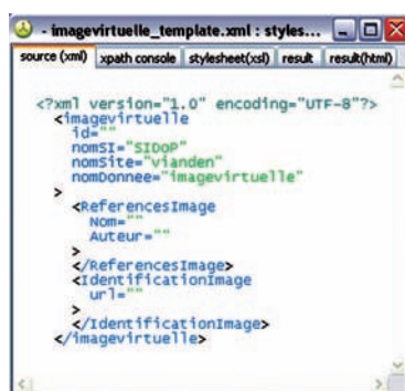
FIG. 7.10 – Schéma XML du nouveau type de donnée imagevirtuelle
