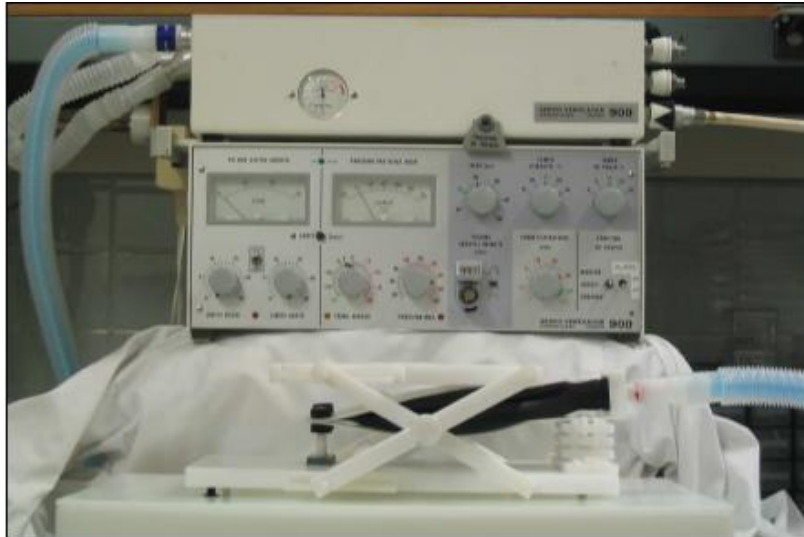
Figure 1-23 Plateforme mobile et ventilateur utilisé pour la commande pneumatique
