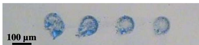
**Figure 4.15 :** Photographie de microscopie optique d'une série de micro-dépôts de silice obtenus sur verre en appliquant à une UME de platine (25  $\mu\text{m}$  de diamètre), placée à 25  $\mu\text{m}$  du substrat, un potentiel réducteur de -1,3 V pendant 60 s dans un sol  $n_{\text{CTAB}}/n_{\text{TEOS}} = 0,32$ .
