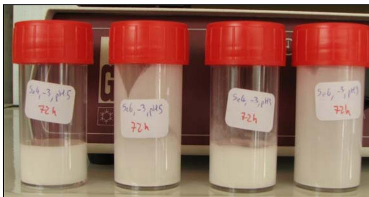
Figure IV-3-1 : Suspensions de rutile mis en contact pendant 72h avec respectivement de gauche à droite :  $[SeO_3^{2-}] = 10^{-3} M$ ,  $pH = 5$ ;  $[SeO_4^{2-}] = 10^{-3} M$ ,  $pH = 5$ ;  $[SeO_3^{2-}] = 10^{-3} M$ ,  $pH = 3$ ;  $[SeO_4^{2-}] = 10^{-3} M$ ,  $pH = 3$ . Force ionique  $[NaClO_4] = 10 mM$ .
