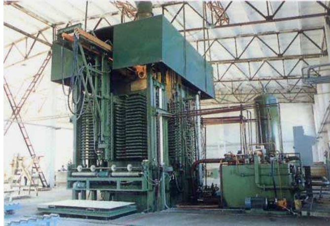
Figure II.38. Dispositif industriel pour le pressage des panneaux de contreplaqués.
