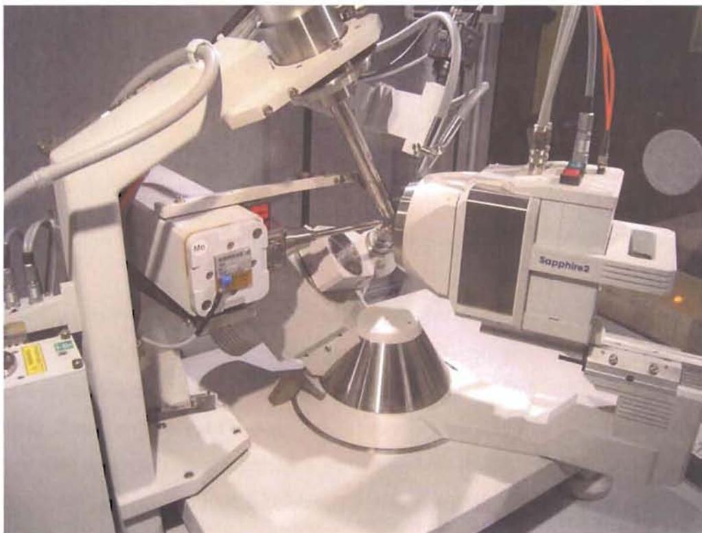
**Figure 10.** Le diffractomètre automatique 4 cercles Xcalibur2 Oxford Diffraction.
